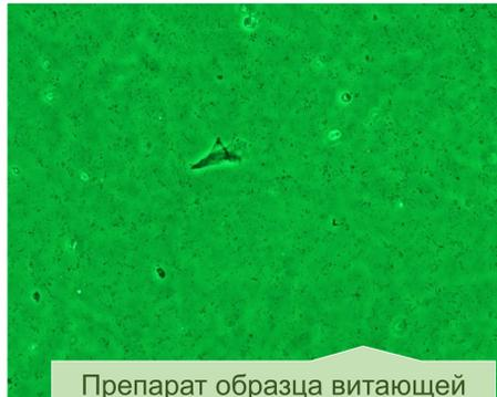
Препарат образца витающей пыли, отобранного из воздуха рабочей зоны токаря по обточке асбестоцементных изделий
