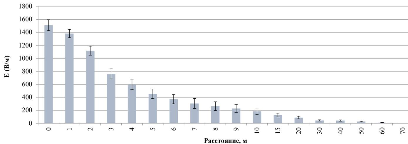
**Пример затухания магнитных полей тока промышленной частоты 50 Гц до фоновых значений от линий электропередачи напряжением 110 кВ**
