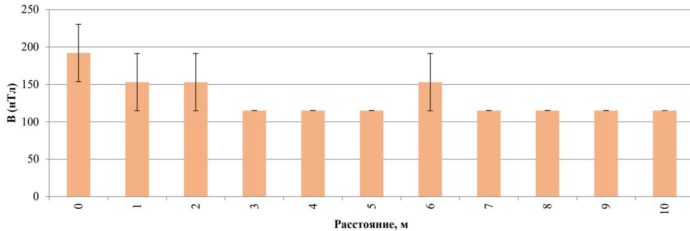
**Пример затухания электрических полей тока промышленной частоты 50 Гц до фоновых значений от ВЛ напряжением 110 кВ**
