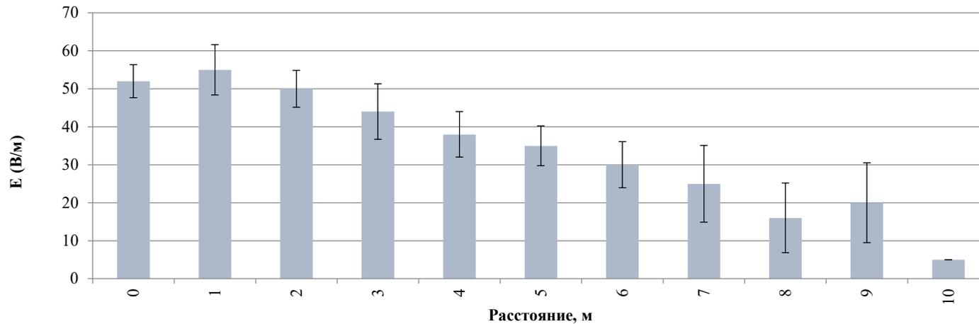
**Пример затухания магнитных полей тока промышленной частоты 50 Гц до фоновых значений от линий электропередачи напряжением 10 кВ**
