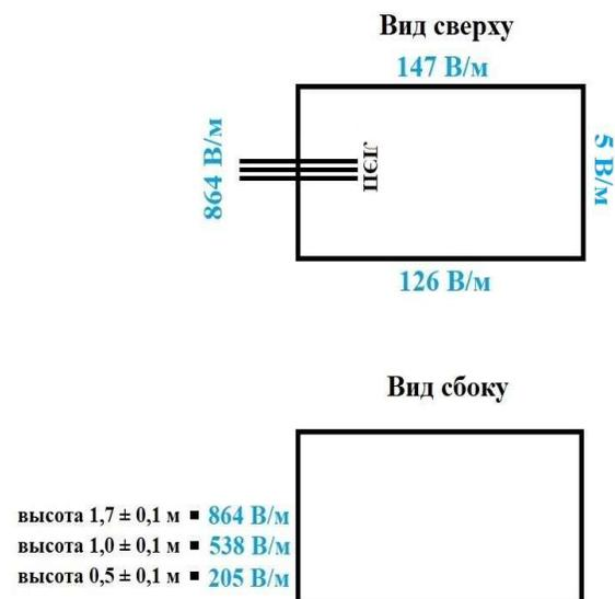
Рис. – Распределение уровней напряженности ЭП тока промышленной частоты 50 Гц электрической подстанции «Петровщина»
