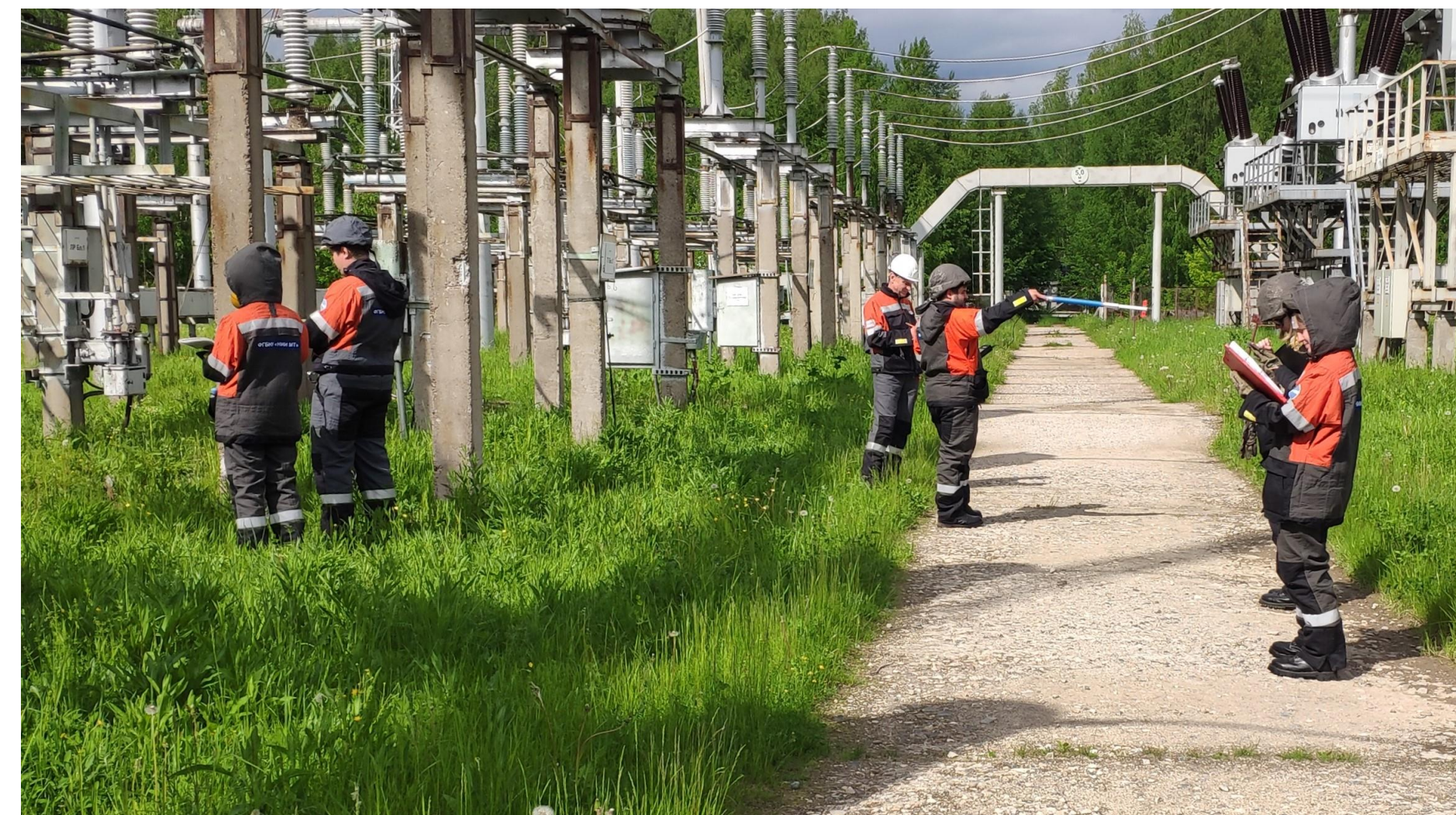
Проведение инструментальной оценки уровней ЭМП на территории ОРУ 220 кВ
