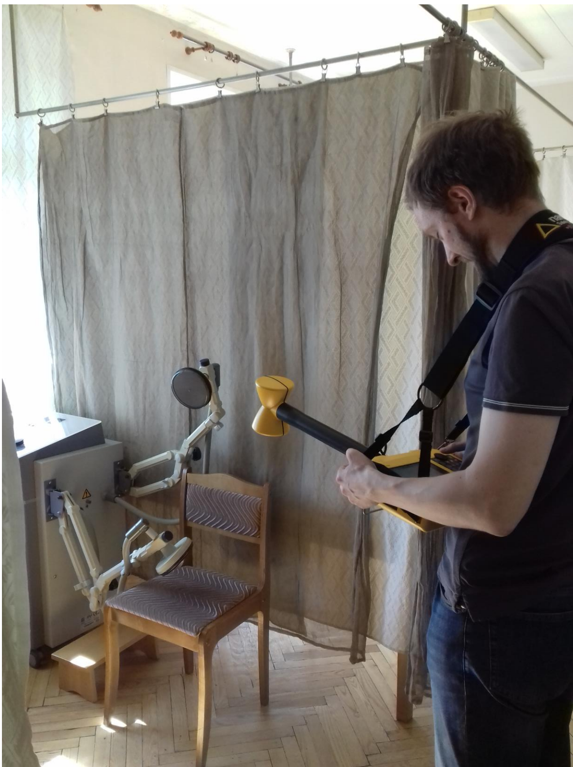
Проведение инструментальной оценки уровней ЭМП около аппарата УВЧ-терапии при помощи Narda SRM- 3006
