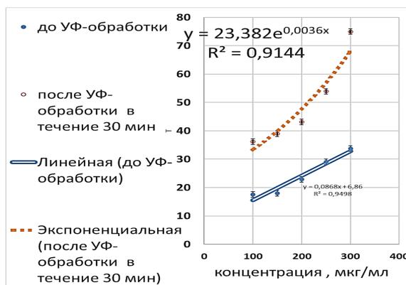
Зависимость показателя Т от концентрации суспензии графена с тиомочевинной до и после УФ-обработки
