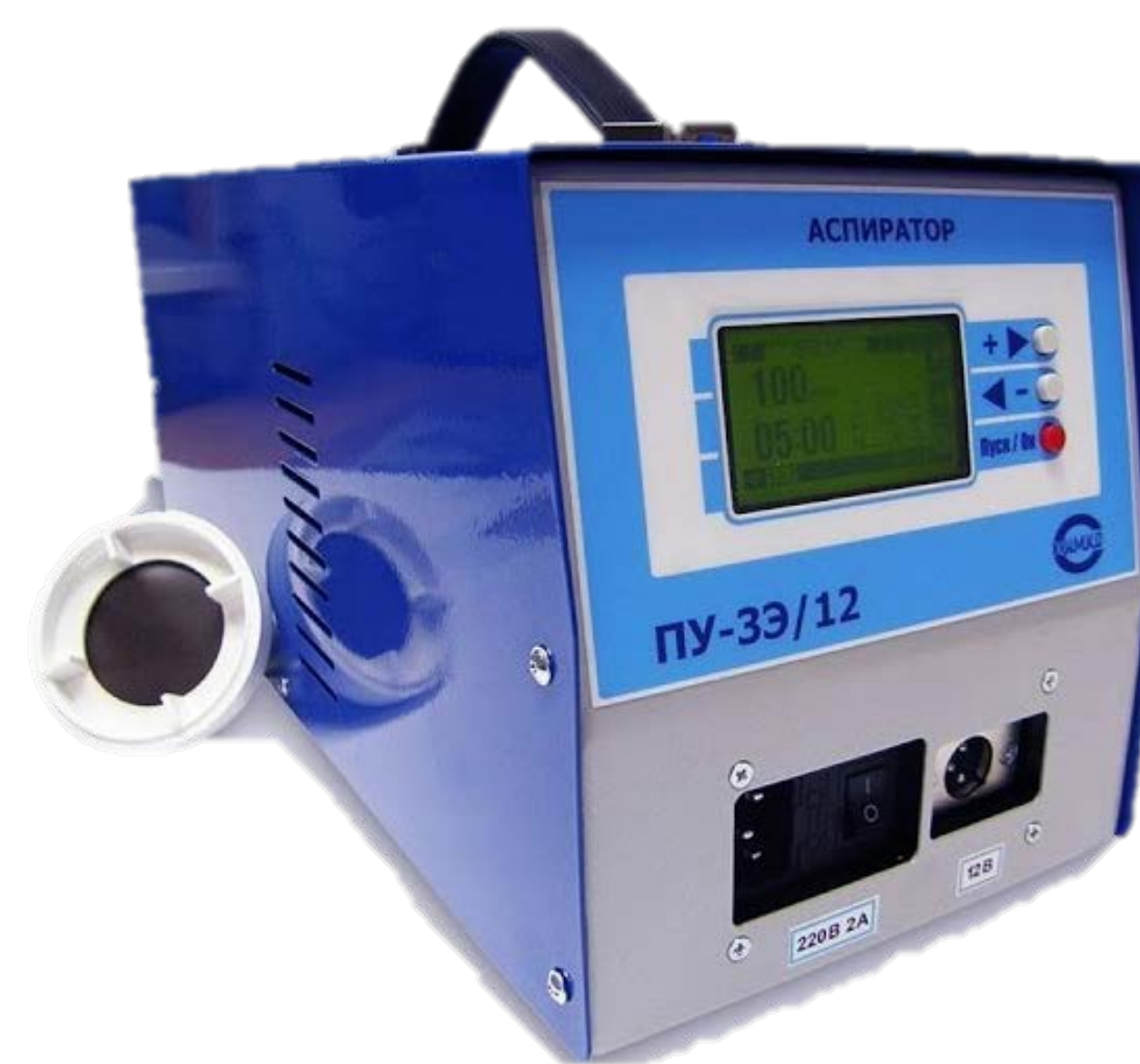
Рисунок 3 – Аспиратор воздуха ПУ-3Э исп.1 («12»)
