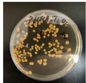
Рисунок 2 – Чашки с S.aureus ATCC 6538 при воздействии образца TiO_2 и ультрафиолетового излучения
