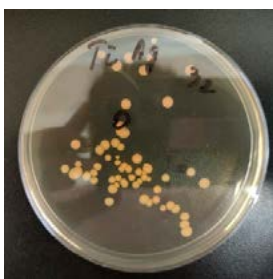
Рисунок 1 – Чашки с S.aureus ATCC 6538 при воздействии образца Ti-Ag и ультрафиолетового излучения
