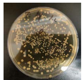
Рисунок 4 – Чашки с S.epidermidis ATCC 12228 при воздействии образца Ti-Ag и ультрафиолетового излучения
