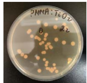
Рисунок 2 – Чашки с S.aureus ATCC 6538 при воздействии образца TiO_2 и ультрафиолетового излучения
