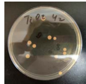
Рисунок 2 – Чашки с S.aureus ATCC 6538 при воздействии образца TiO_2 и ультрафиолетового излучения
