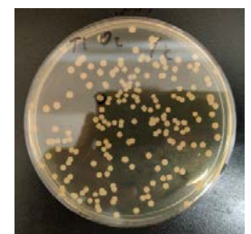
Рисунок 5 – Чашки с S.epidermidis ATCC 12228 при воздействии образца TiO_2 и ультрафиолетового излучения
