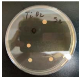
Рисунок 2 – Чашки с S.aureus ATCC 6538 при воздействии образца TiO_2 и ультрафиолетового излучения
