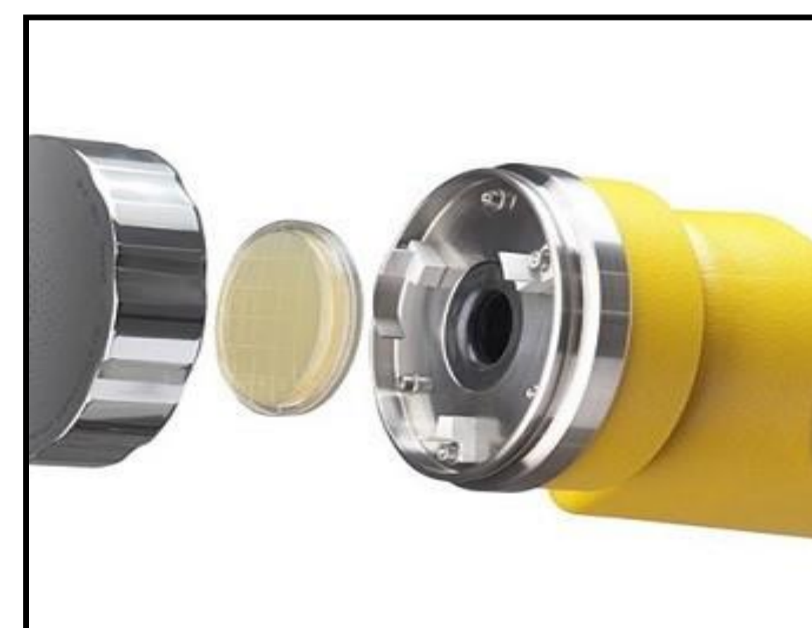
Аспирационный способ отбора проб воздуха
