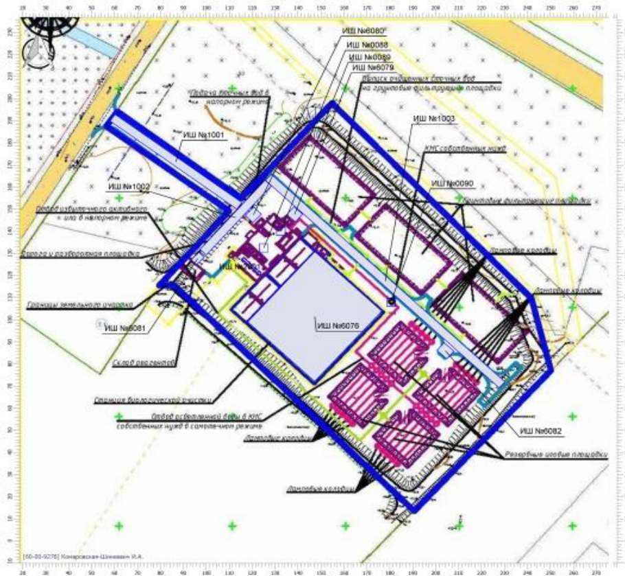
Оценка источников шума, расположенных на производственной площадке объекта
